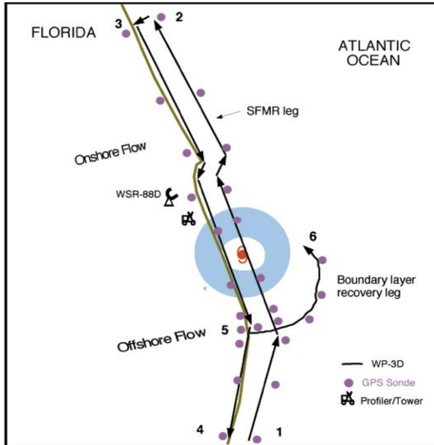
*Figure EN-2. Coastal Survey module*
