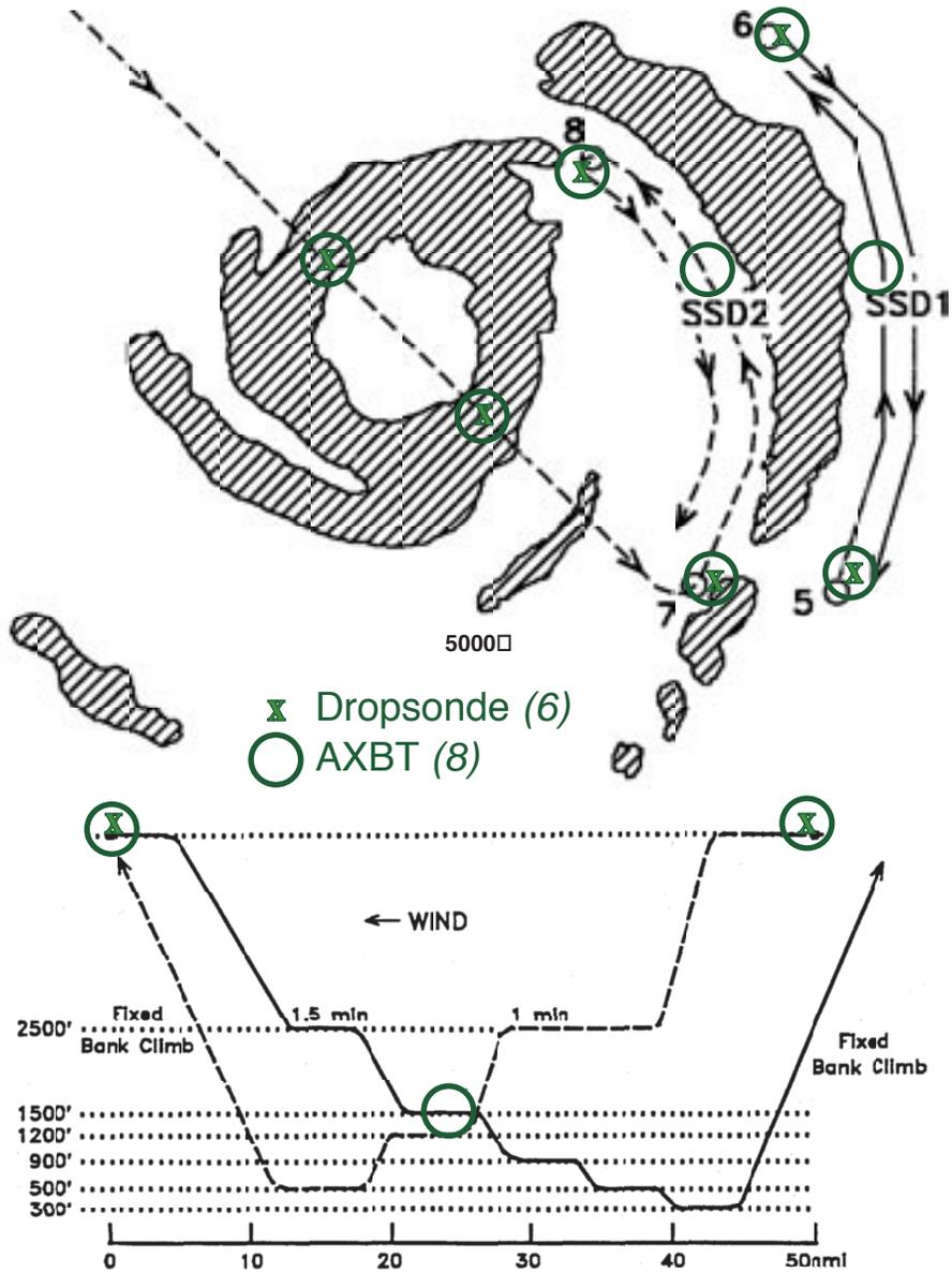
**Fig. 5. CBLAST Option Pattern**
