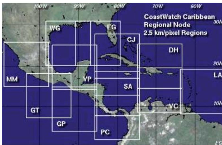
**Fig. 3.** EL CWC proporciona datos en varias zonas de interés o *masters*. En la figura superior se muestran los masters con resolución de 2.5 km/píxel. Otras resoluciones son 1, 5 y 10 km/píxel.
