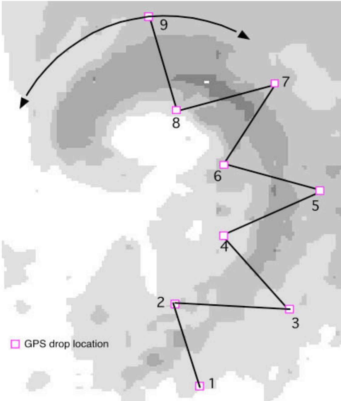
**Figure 9a Rainband test pattern: Single Aircraft Option**
